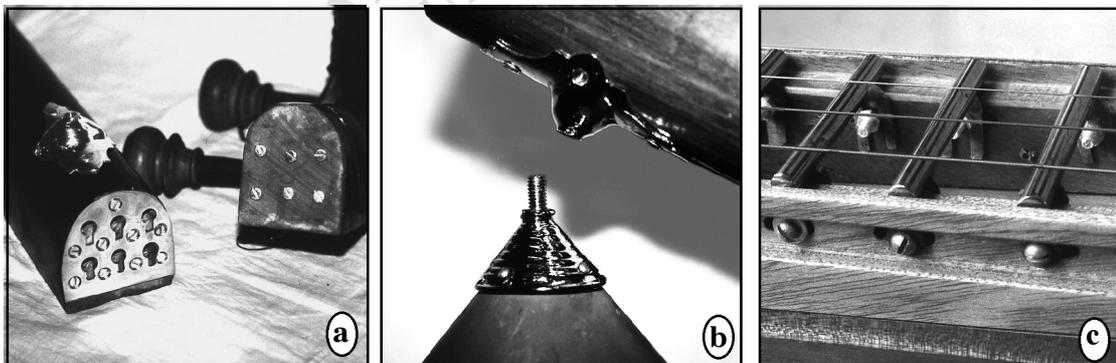
**Fig. 136 : Trois inventions de Narasinga Rao : Le système d'accrochage des trois parties du corps entre elles (ici joint manche / chevillier) (a), le raccord fileté du résonateur extérieur (b), et les frettes ajustables sur support de bois (c).**
