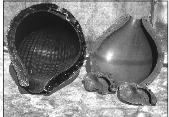
**Fig. 131 : Moules pour caisses de *vīṇā-s*, de *tamburā-s* plats, et pour *yālī-s* en fibres de verre**
